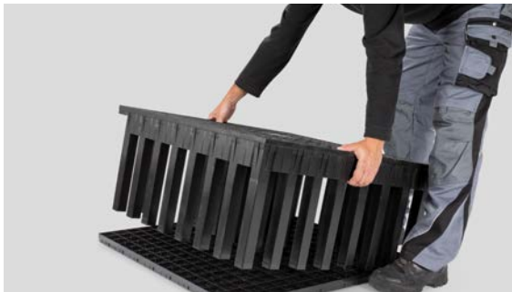
Korrekte Positionierung und Ausrichtung des Grundelementes über dem Bodengitter, anhand der Pfeilmarkierungen an beiden Bauteilen
