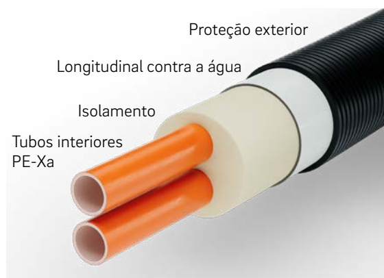
Fig. 03-3 Componentes principais do RAUVIPEX
